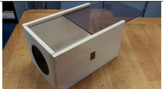
Projektarbeit: Einsatz der KOSY-Fräse für Schiebedeckel und 7-Segment-Anzeige
